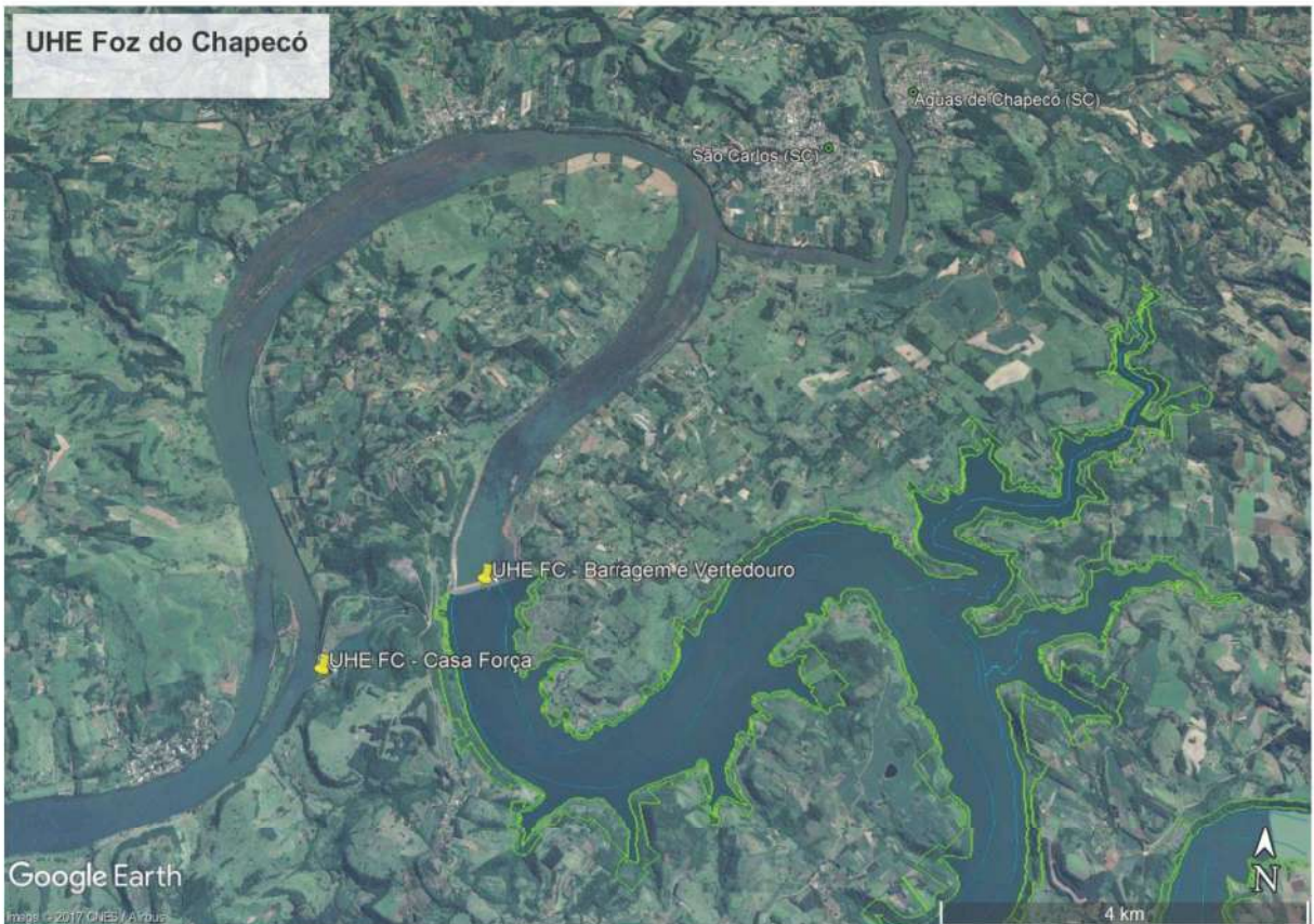
Figura 3. UHE Foz do Chapecó: alça de vazão reduzida.
